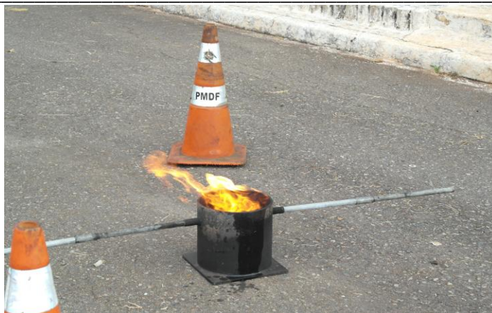
Figura 13 – kit Tolva (instrumento utilizado na inutilização de Granadas Policiais Falhadas).
