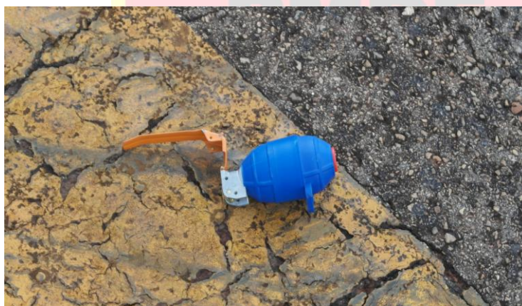
Figura 14 – Exemplar de Granada policial de treinamento – M4 Falhado e ainda preservando a Espoleta e a Alavanca de Segurança, (conjunto da EOT).
